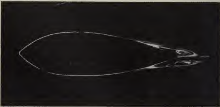
FIG. 175.—Eddy motion behind long strut (N.P.L.).
